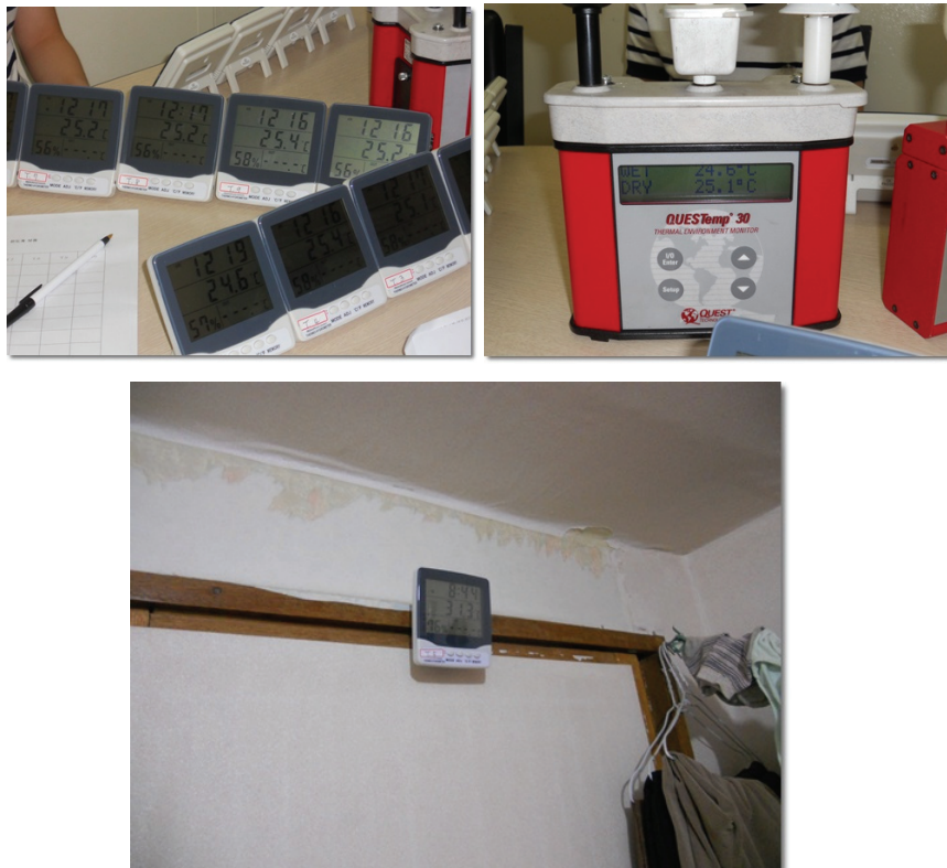
[그림 1] 온도계 보정(왼쪽 위: 측정에 사용된 온도계, 오른쪽 위: 보정을 위한 WBGT 온도계) 및 쪽방 설치(아래) 장면
