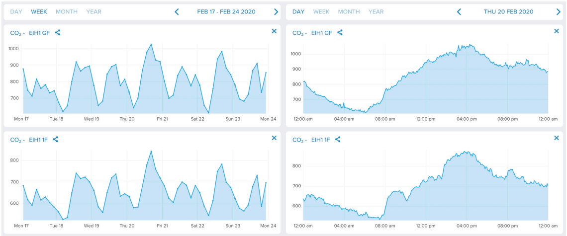
그림 3: 24시간 기계식 환기를 하는 최우석 본인의 집(에너지독립하우스 1호; EIH1)의 주간 이산화탄소 농도 그래프(GF=1층, 1F=2층). 낮에 주로 생활하는 1층의 이산화탄소 농도가 더 높다. 1, 2층 고르게 1,000 ppm 이하를 유지하고 있다. 패턴을 보면 오후 4시 전후에 최고점에 달했다가 활동량과 호흡량이 줄어드는 취침시간대에 지속적으로 농도가 떨어져서 아침 무렵 최저에 달한다. 24시간 환기가 되기 때문이다. 자연 환기를 하는 집과는 확연히 다른 패턴을 그린다.
